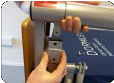
Løft opp og sett på forhøyertopp
