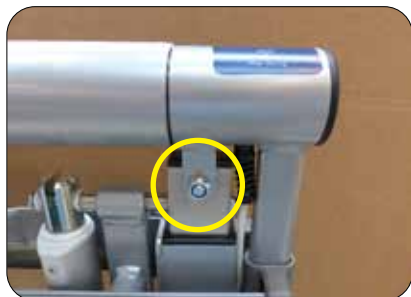
Demonter motorrullen fra aktuatorbenet.
