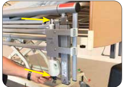
Sett på boltene igjen og skru til en ende om gangen
