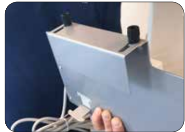
Løse skruene på opphengsplatene til kontrollenheten
