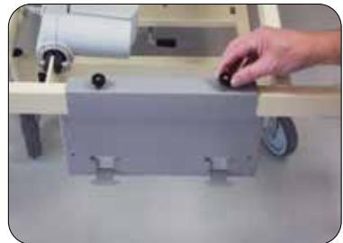
Skrue fast opphengsplatene med de to fingerskruene
