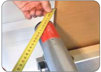
Juster plasseringen av VENDLET-systemet på sengerammen, slik at det maksimalt er 6 cm i mellom sengegavlene og VENDLET-systemet
