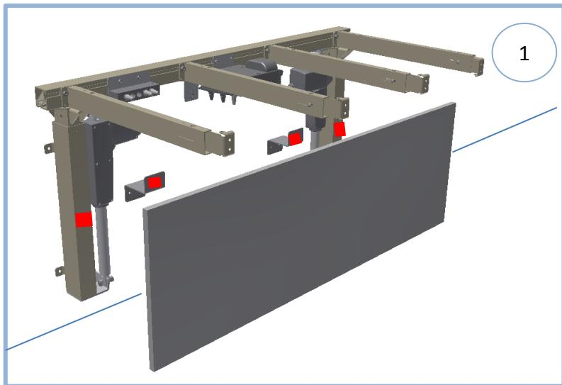
1. Z-Beslagene monteres på veggen. Det monteres velcro på benenes forside, på Z-beslagene og på den siden av nedre dekselplate som vender inn mot veggen. Velcroen på platen må treffe velcroen på ben og z-beslag, og krok/løkke må få feste.
