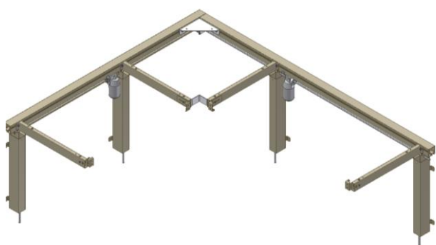
6.1.21 Når alle ben og knegter er rettet inn og plassert i den ønsket position, strammes alle skruer!
