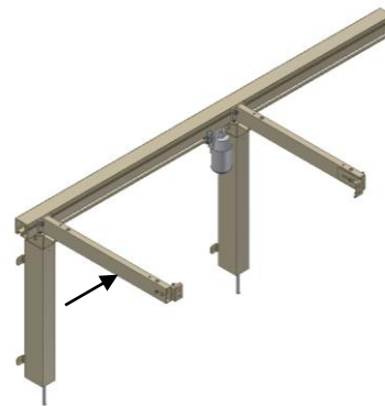
6.1.8 Enda en knegt plasseres over det nye benet. Hvis det skal benyttes ekstra knegter mellom de to viste, skal disse skyves inn forinden. Skruene skrues løst til.
