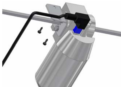
6.1.1 Sekskant aksel og motorkabel monteres.
