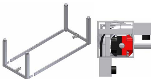
6.1.4 Herefter monteres de to forsarge. Det er meget vigtigt at både side- og forsarg bliver trykket hårdt ind mod benet inden sargene bliver efterspændt. Sørg for at spænde boltene hårdt med medfølgende nøgle.
